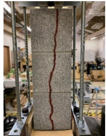
B: 降伏→CB割裂 C: CB割裂
