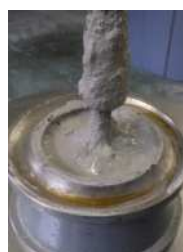
(a) 突き棒への付着 (b) フローコーンへの付着
