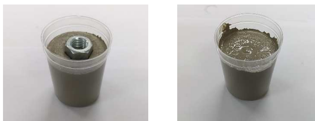
(a)ナットが沈まなかった例 (b)ナットが沈んだ例 写真1 沈降試験状況
