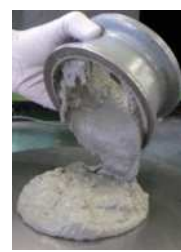
(a) 突き棒への付着 (b) フローコーンへの付着
